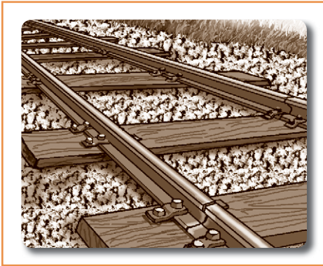
Gambar 6.2 Sambungan rel kereta api dipasang agak renggang agar tidak melengkung saat memuai akibat kepanasan.
